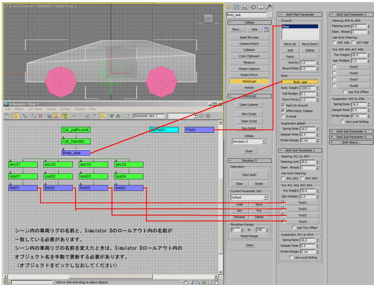
Simulator D のロールアウト内に表示された各オブジェクトと、シーン内の車両リグの名前が一致していないとスクリプトは正常に動作しません。
